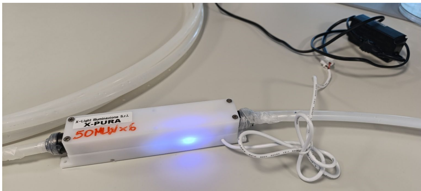
Fig. 5 – Sistema X-PURA in funzione durante il passaggio d'acqua contaminata
